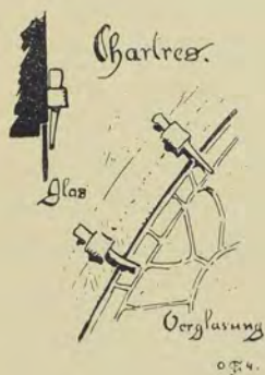
294. Befestigung von außen eingesetzter Lichtgadenfenster der Kathedrale von Chartres. (Nach einer Handskizze des Verfassers.)
