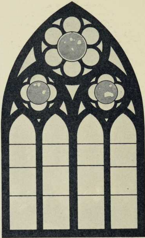
242 Bestandsaufnahme des (von Osten gezählt) sechsten Fensters des südlichen Seitenschiffes. Lichte Breite 4,55 m
