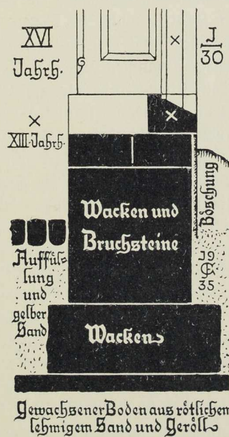
13 Querschnitt durch Fensterbrüstung und Mauersockel auf der Westseite der Gerichtslaube
