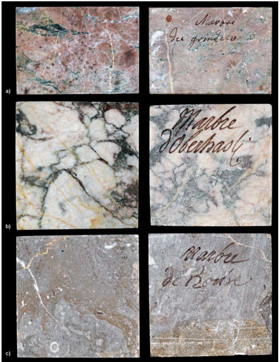
a) Vorderseite und Rückseite eines Marmormusters von Grindelwald, b) Vorderseite und Rückseite eines Marmormusters von Oberhasli, c) Vorderseite und Rückseite eines Marmormusters von Roche.
