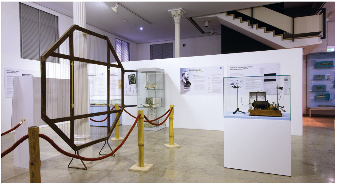
Abbildung 7. Im Vordergrund Versuchsanordnungen zu HEINRICH HERTZ, die vom Karlsruher Institut für Technologie (KIT), Fakultät für Physik, zur Verfügung gestellt wurden. Links das HERTZ'sche Gitter (in einem Nachbau von 1957), rechts Sender und Empfänger bestehend aus Funkeninduktor, zwei Antennen, Anzeigegerät und Akku. Die Originalgeräte befinden sich im Deutschen Museum in München. Am 13. November 1886 gelang HERTZ erstmals die Übertragung elektromagnetischer Wellen von einem Sender zu einem Empfänger. Der Drahtgitterpolarisator für elektromagnetische Wellen ist für Wellen durchlässig, deren elektrisches Feld senkrecht zu den Drähten schwingt. Bei Parallelität reflektiert das Gitter wie eine leitende Fläche.
