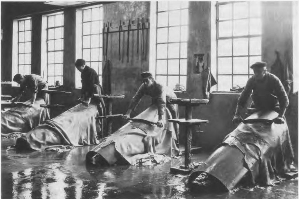
Abb. 4: Die Lederverarbeitung war auf eine gute Wasserversorgung angewiesen. Das Foto zeigt Scherböcke in der Wasserwerkstatt der Friedrichshafner Lederfabrik Hüni & Co. (Quelle: Hüni Familienarchiv)
