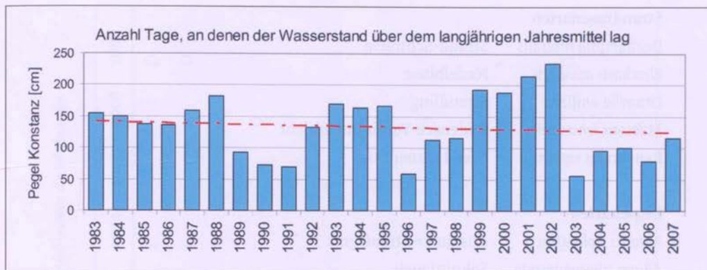
Abb. 2: Anzahl der Tage in den Jahren 1983 bis 2007, an denen der Pegel Konstanz (PK) über dem langjährigen mittleren Mittelwasser (337 cm PK für den Zeitraum 1951–2000) lag.
