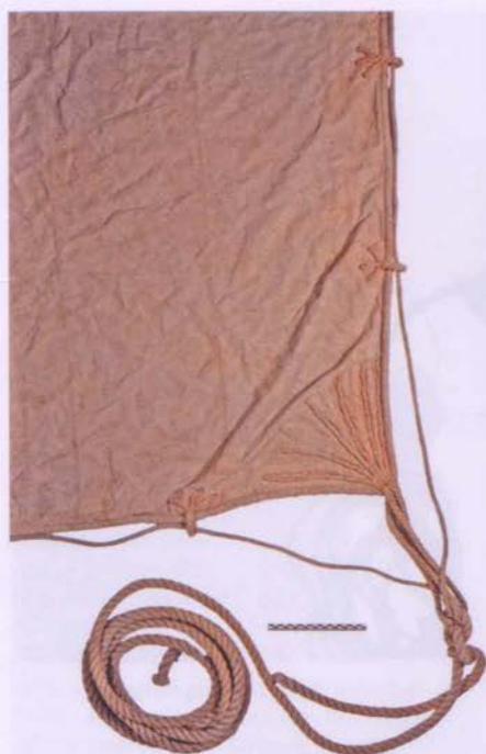
Abb. 9 Doppelschlaufe am Schothorn mit fächerförmig aufgenähten Litzen und dicker Schot (»Fuß«, Ansicht von der Leeseite)
