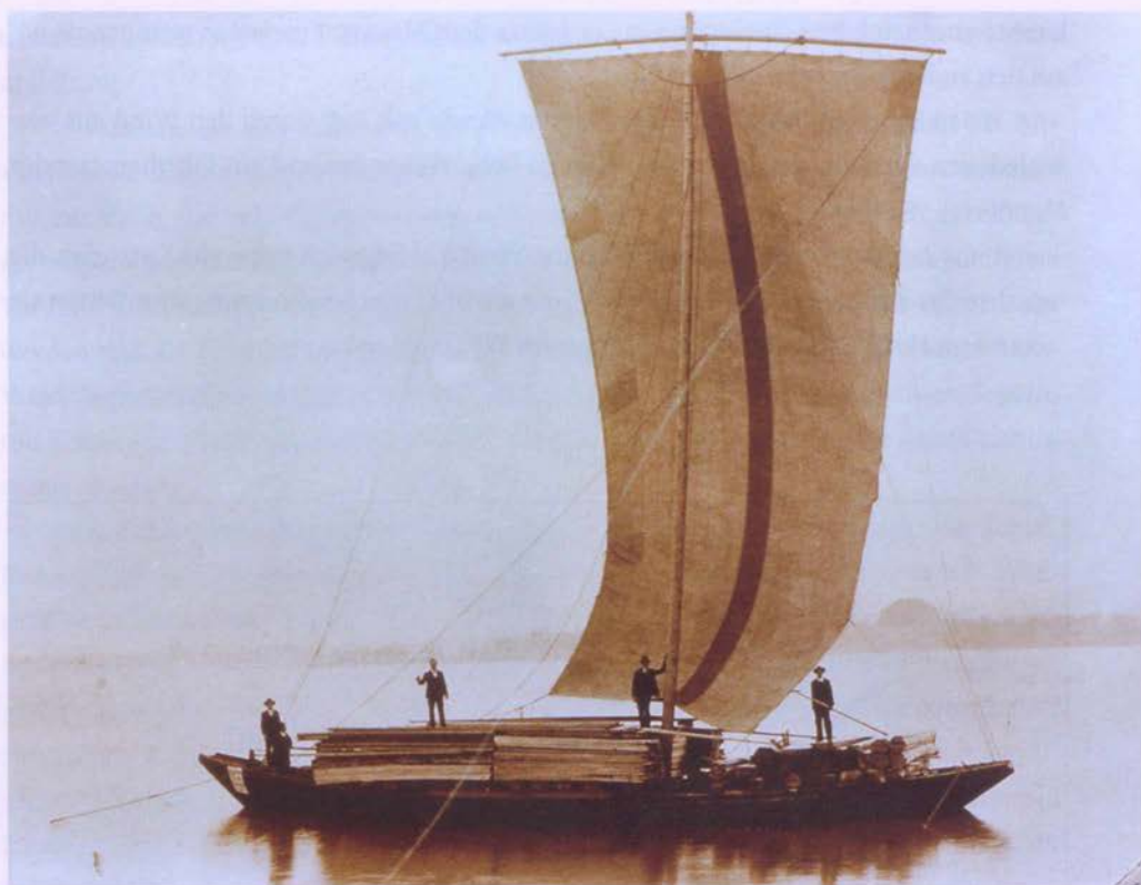
Abb. 32 Ein Lastsegelschiff des Eigners Gälli aus Horn mit Bretterladung vor Steinach SG, vor 1906. Am Bug der Schiffmann Ferdinand Zöllig, rechts vom Segel die Silhouette des Gredhauses von Steinach. Mithilfe der Leinen an den Seitenlieken des Segels (»Schnür«) war es möglich, die Segelstellung dem Seitenwind anzupassen und das Seitenliek so zu verzurren, daß es nicht ins Flattern kam oder eingedrückt wurde. Die »Schnür« sollten dem Rahsegel die fehlende feste Anströmkante geben und es in einem optimalen Anstellwinkel fixieren. (Seemuseum Kreuzlingen)
