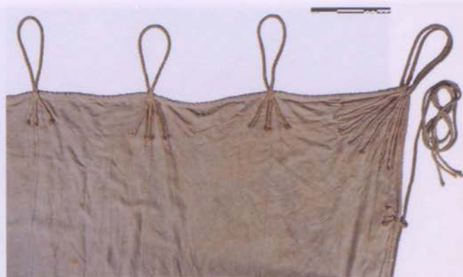
Abb. 10 Nocklegel an der oberen Ecke mit fächerförmig aufgenähten Litzen und den gekreuzten Nähten der Eckdopplung sowie Schlaufen am Oberliek zum Durchstecken der Rah (Ansicht von der Leeseite). Rechts das eine Ende der umlaufenden Leine.
