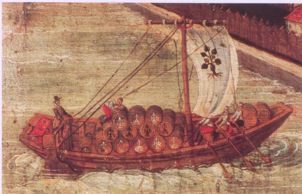
Abb. 23 Darstellung eines Lastsegelschiffes, Lindau 1604. Ausschnitt vom Epitaph der Kaufmannsfamilie Deller. Deutlich zu erkennen sind Segel und Takelage mit den »Schnür«, die aufgeschossen von den Seitenlieken herabhängen. Die Rah wird von einem Rack mit Holzkugeln am Mast gehalten (Stadtmuseum Lindau, Haus zum Cavazzen)
