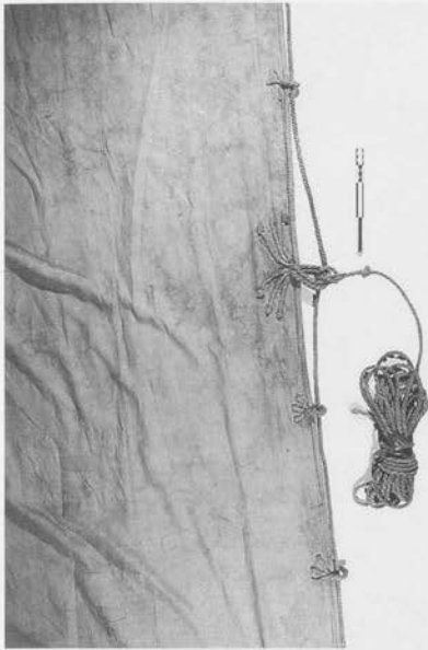
Abb. 13 Oberste große Schlaufe links (Luv-seite), Ansicht von der Leeseite. Die »Schnur« ist mit einer lösbaren Schlaufe befestigt.
