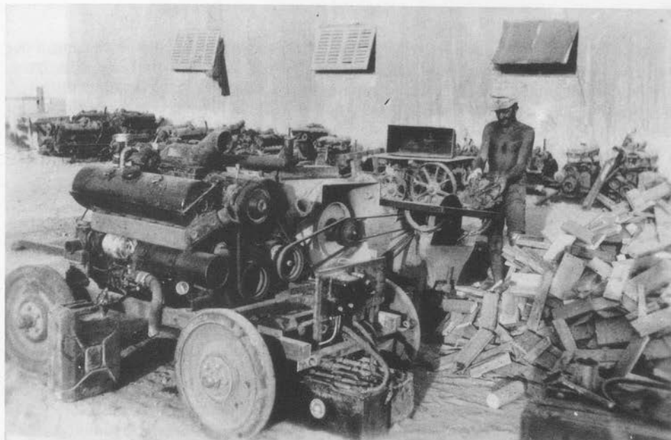
Abb. 4 Symbolische »Konversion« von Rüstungsgütern in zivile Nutzung bei der Firma Maybach. Nutzung eines Maybach-Panzermotors HL 120 als Antrieb einer Brennholzsäge auf dem Firmengelände, um 1945/46; im Hintergrund weitere Motoren für Panzer und Halbkettenfahrzeuge.
