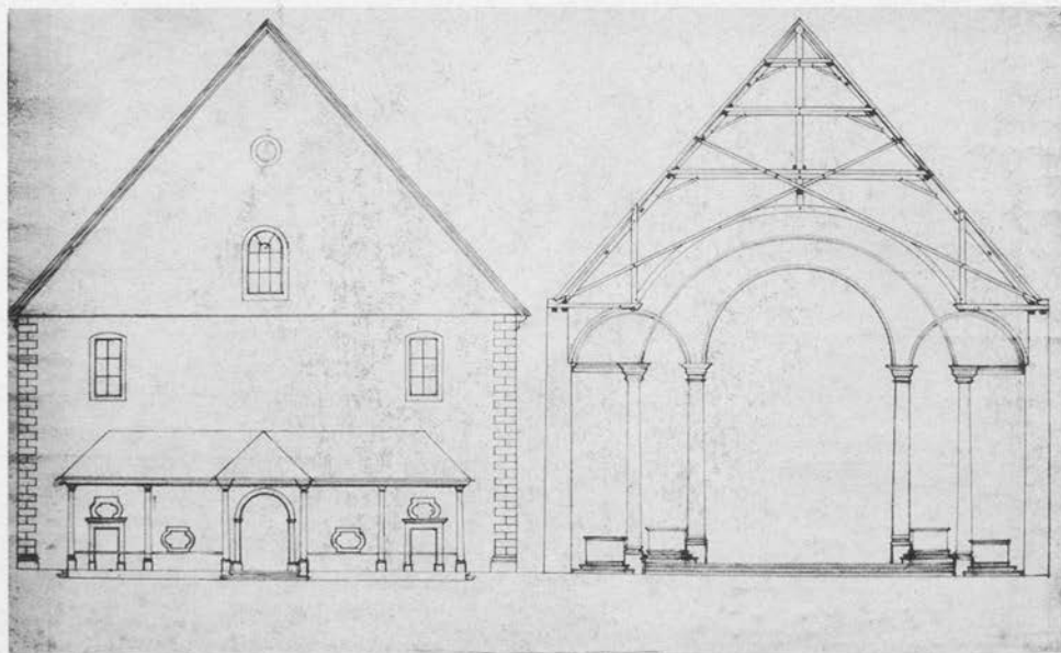
144 Fassade und Querschnitt
