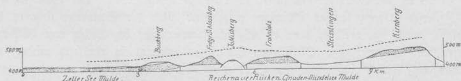
Fig. 6. Querschnitt von Steißlingen bis Singen. Die Meeresmolasse ist punktiert. Die gestrichelte Linie bedeutet das Auf- und Absteigen der oberen Grenze der Meeresmolasse, 50 Meter höher als Rücken und Mulde gezeichnet.
