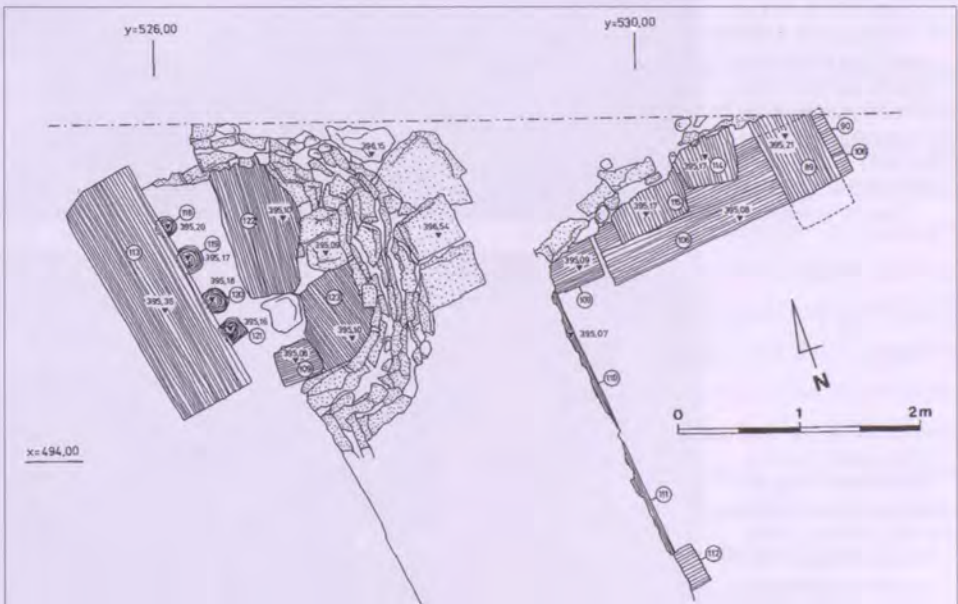
Abb. 26: Das Fundament des Beintürmles im Zustand der Ausgrabung mit starken, waagrecht liegenden Eichenbohlen und einer dichten Pfostensetzung darunter (Landesamt für Denkmalpflege Baden-Württemberg im Regierungspräsidium Stuttgart, Arbeitsstelle Konstanz, Zeichnung: C. Bürger).
