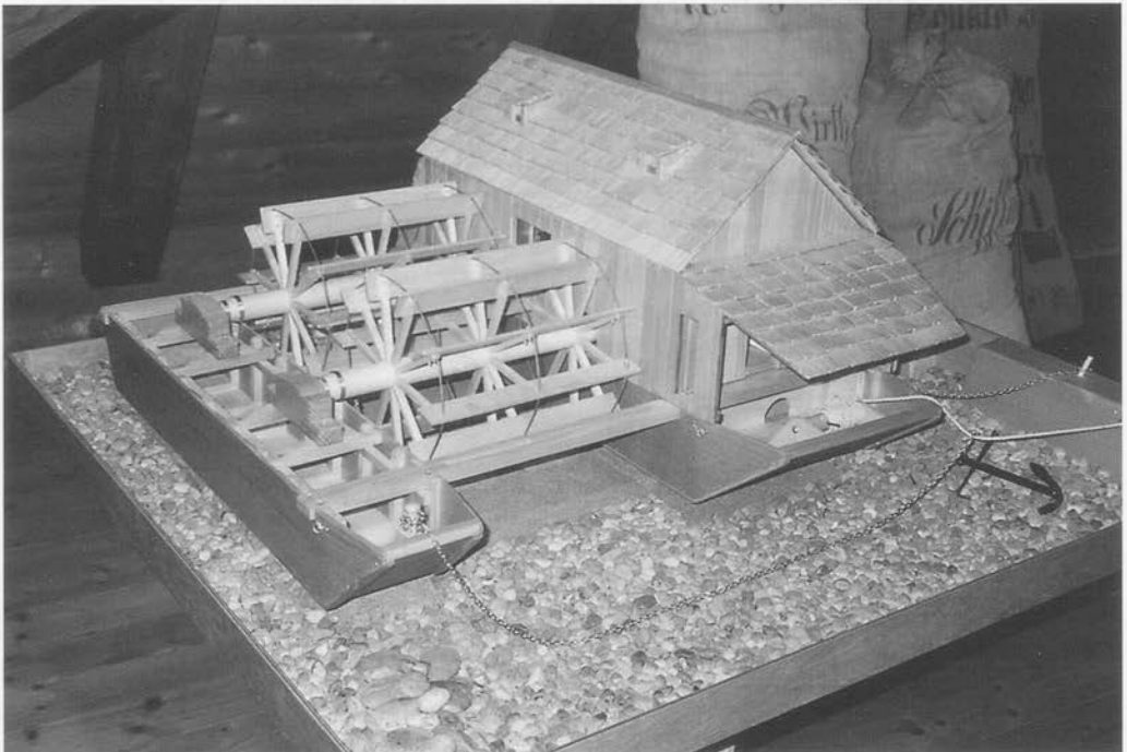
Abb. 5 Rechtsufrige Schiffmühle in Eglisau, Modell im Ortsmuseum, erstellt nach historischen Bildern ab 1730 (Foto des Verfassers)
