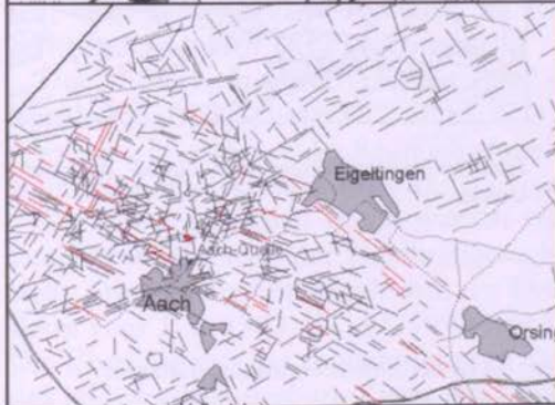
Abb. 14 b Mögliche Zusammenhänge zwischen dem Vorkommen von Karstquellen, Lineationen auf Satellitenradar-aufnahmen und der Bruchtektonik im Gebiet der Aachquelle
