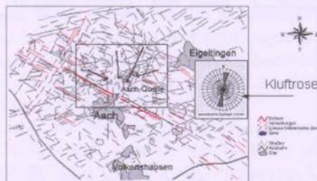
Abb. 16 Lineationskartierung auf der Basis der Satellitenradaraufnahmen vom 10. 4. und 2. 10. 1994
