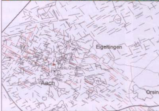
Abb. 14 a Kartierung linearer Bildelemente auf der Basis von Satellitenradar-aufnahmen und ihrer farbkodierten Bildprodukte
