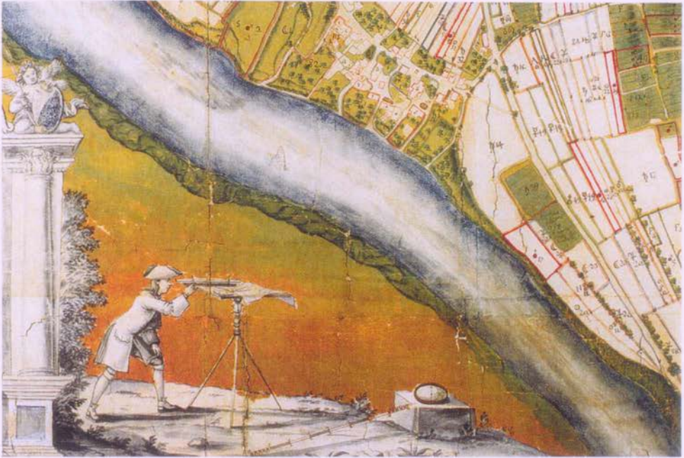
Abb. 1 Ein Zeitgenosse Johann Jacob Hebers, der Feldmesser Schäppi, bei den Vermessungsarbeiten zur Herstellung eines Gemarkungsplans im Herrschaftsbereich der Stadt Stein am Rhein. Als Messgeräte dienen Messtisch mit Diopterlineal, Messstange, Kompass und Zirkel. Nach Messen einer Grundlinie können von den beiden Endpunkten aus weitere Geländepunkte mit dem Diopterlineal angezielt und diese Richtungen graphisch auf den Papierbogen auf dem Messtisch übertragen werden. Der Gemarkungsplan entstand als Produkt der Feldvermessung vor Ort; Fertigstellung wie Reinzeichnung und Kolorierung erfolgte zu Hause. Die Genauigkeit der Gemarkungspläne entspricht nicht immer den heutigen Genauigkeitsanforderungen (Stadtarchiv Stein am Rhein, Depositem Kanton Schaffhausen, Nr. 16383).
