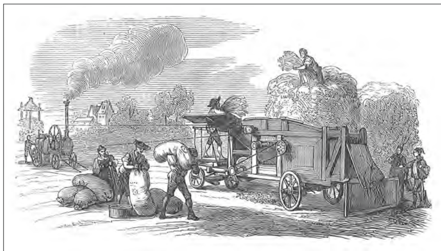
Dreschmaschine, angetrieben durch eine Lokomobile (aus Julius v. Hügel/Georg Friedrich Schmidt:
