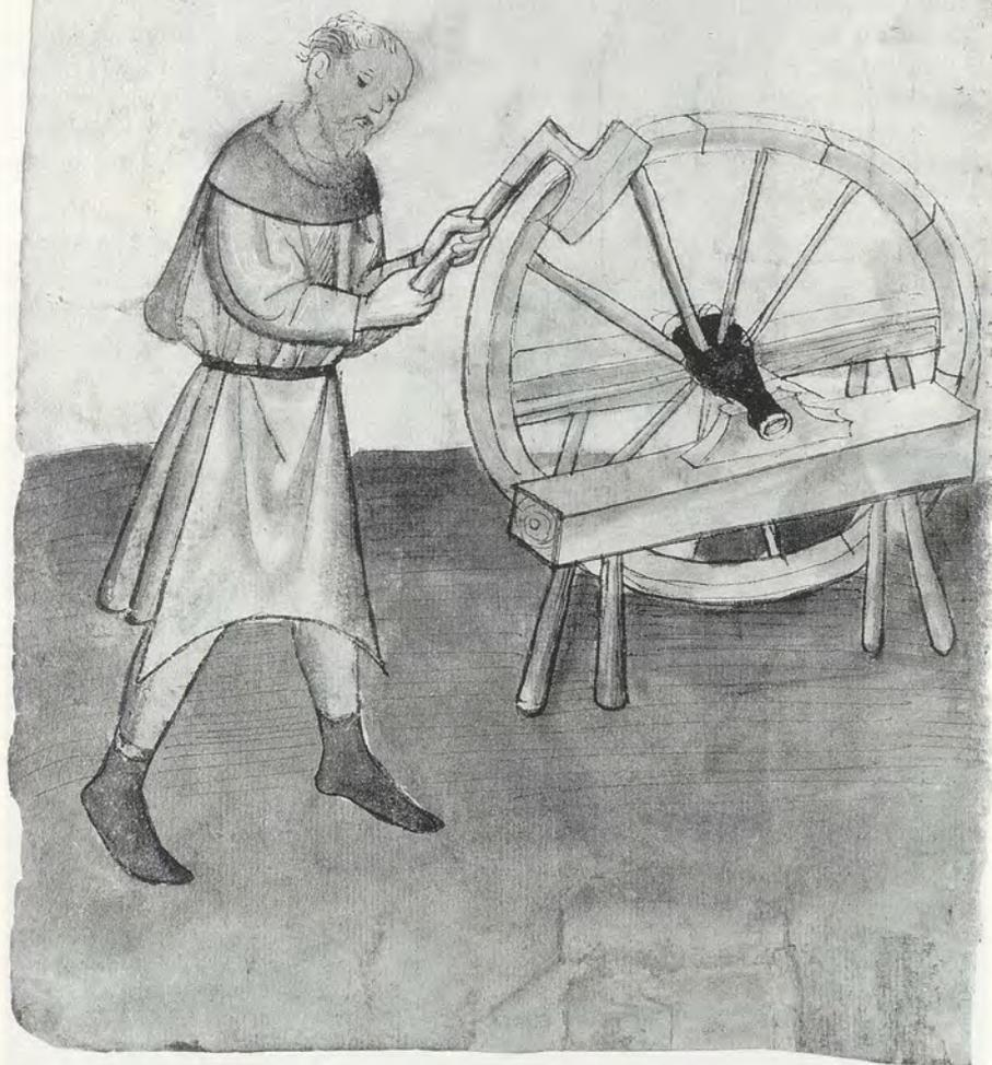
Abb. 4: Hans Wagner, ein Wagner, 1431, der 107. Bruder im Hausbuch der Mendelschen Zwölfbrüderstiftung zu Nürnberg beim Bearbeiten eines Rades längs der Faser mit einer langschneidigen Doppelbartaxt
