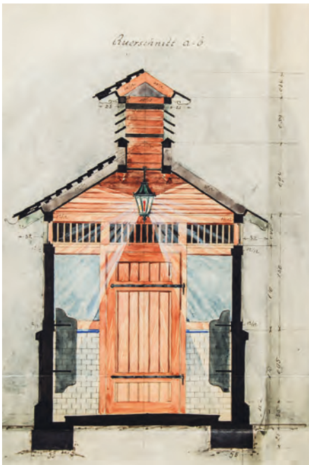
Entwurf einer Toilette am Schillerplatz. Querschnitt mit Gasbeleuchtung (links) und Außenansicht (rechts), Oktober 1905.
