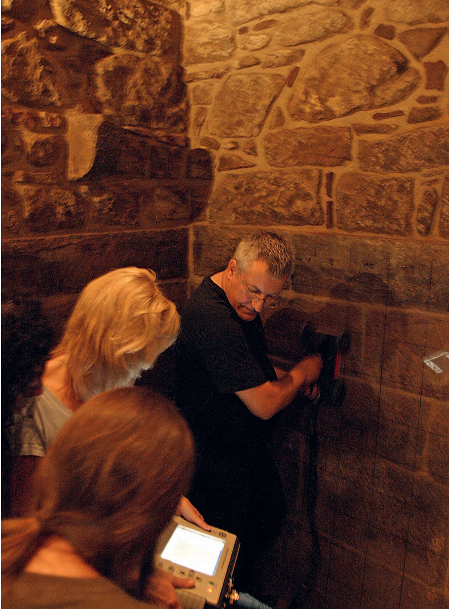
Abb. 6: Geophysikalische Messung im Badeschacht der Offenburger Mikwe. Im Zuge der Machbarkeitsstudie konnten lediglich die unteren 2 m gemessen werden. Weitergehende Untersuchungen erfordern den Einbau eines Gerüsts. Aufnahme: Valerie Schoenberg.
