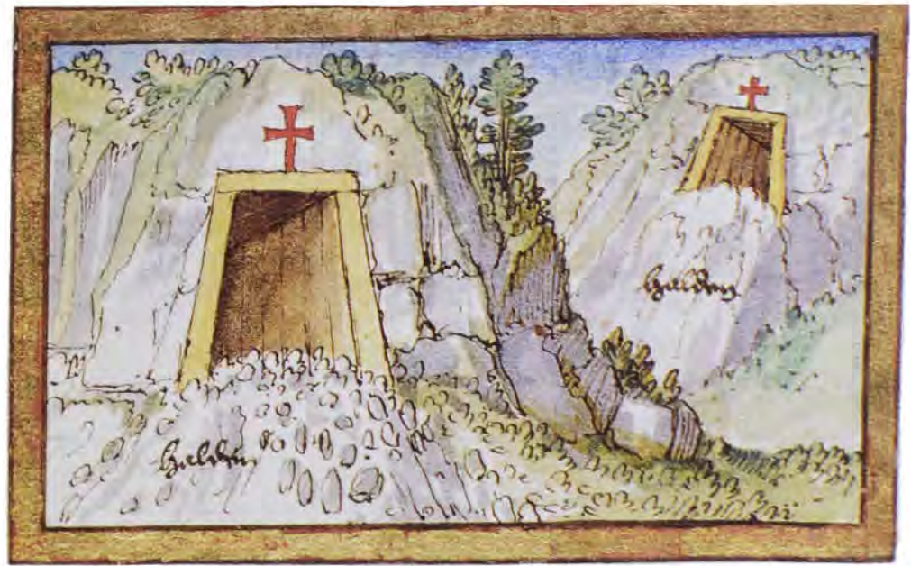
Abb. 18 Holzgerüst für Stollenmundlöcher und als Halt für die Abraumbalden.
