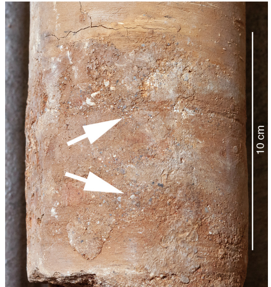
Abbildung 17. Klastischer Gang mit sandiger Füllung (Pfeile) in LE 36 (Kernabschnitt 28,75-28,65 m).
