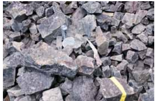
Abbildung 13. Typische Blockgröße in der Halde Karlsruher Grat (Ø 5-30 cm). – Foto: H. HÖFER.
