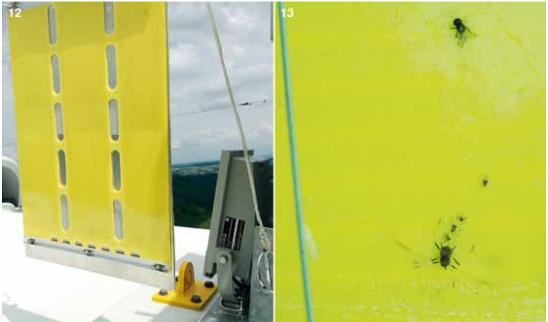
Abbildungen 12, 13. Gelbkarte als Klebefalle nach zwei Wochen Exposition (Detail in Abb. 13). Nur wenige Kleininsekten, überwiegend Fliegen und Blattläuse, zeugen von geringer Insektenaktivität in Höhe der WEA-Kanzel auch tagsüber. – Fotos: R. MÖRTER.
