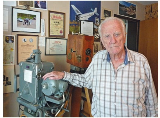
Der 100-jährige Manfred Kranz vor seiner Schmalfilm-Zeitlupe von Zeiss Ikon, ab 1937, mit einstellbaren Aufnahme­frequenzen bis zu 6000 Bilder/Sek., mit Motor, hölzernem Stativ und Zubehör 87 kg schwer, und einer Holzmantel-Filmkamera von Ertel aus dem Jahre 1923 im Originalzustand und betriebsbereit (Fotos und Repros: Werner Klipfel. Die Vorlagen 1–7 stammen von Manfred Kranz, 8 von Werner Klipfel)
