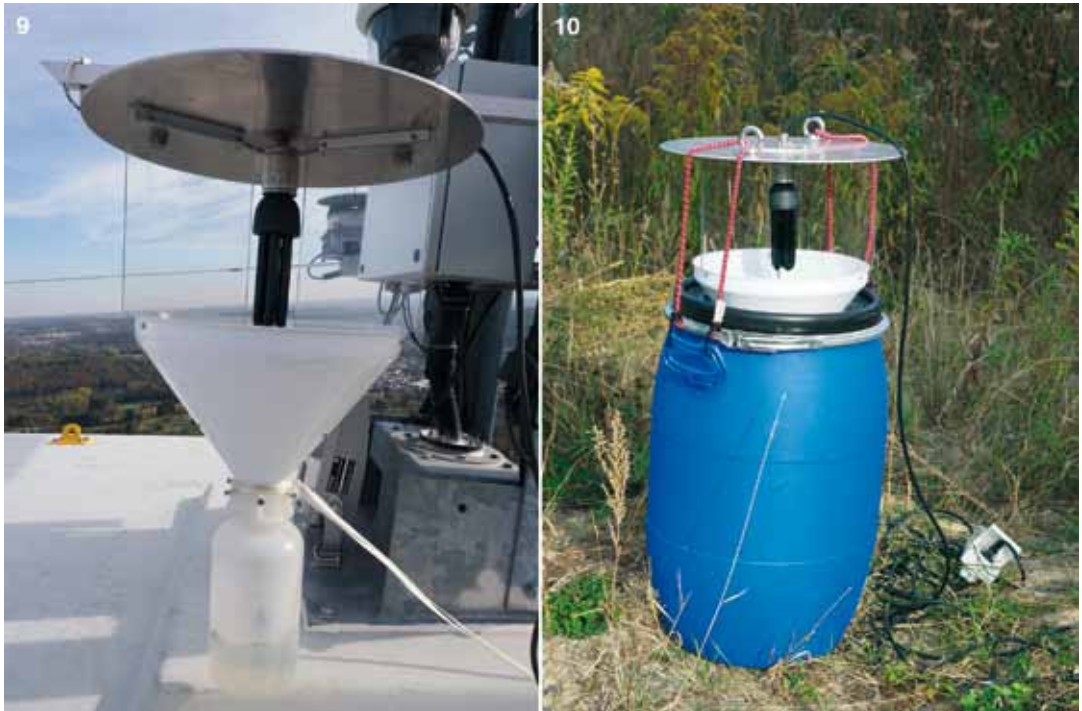
Abbildungen 9, 10. Für diese Studie benutzte Lichtfallen. Auf der WEA-Kanzel (KF, Abb. 9) und am Mastfuß (MF, Abb. 10) kamen baugleiche Fallen zum Einsatz, nur die Art und Weise ihrer Aufhängung bzw. Aufstellung ist verschieden: Während die KF an einem Vierkant-Hohlprofil am „Geweih“ in ca. 100 m Höhe über Grund aufgehängt wurde, war die MF in einem Kunststoff-Fass (Höhe ca. 0,8 m) aufgestellt. Die am Trichter fest verschraubten PE-Sammelflaschen (Polyethylen-Weithalsflaschen, 500 ml) unterscheiden sich in beiden Fällen nicht. – Fotos: R. MÖRTER.
