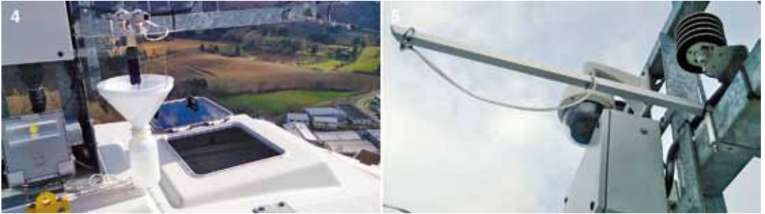
Abbildung 4, 5. Zwischen der Luke (Abb. 4) und dem Signalleuchenträger (dem sogenannten Geweih) (Abb. 5) konnte die Lichtfalle sicher befestigt werden. Ihre Maße sind aber dadurch auf 30 cm Durchmesser und 58 cm Höhe insgesamt (mit Prallscheiben, Trichter und Sammelgefäß) beschränkt. Die Falle wurde von M. FALKENBERG konstruiert und hergestellt. – Fotos: M. FALKENBERG.
