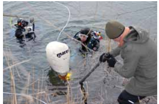
Abbildung 7. Die Unterwasserbohrung ist abgeschlossen, und die Ausrüstung samt Bohrstock wird mit dem Hebesack ans Ufer gebracht. – Foto: ULRICH HEROLD.
