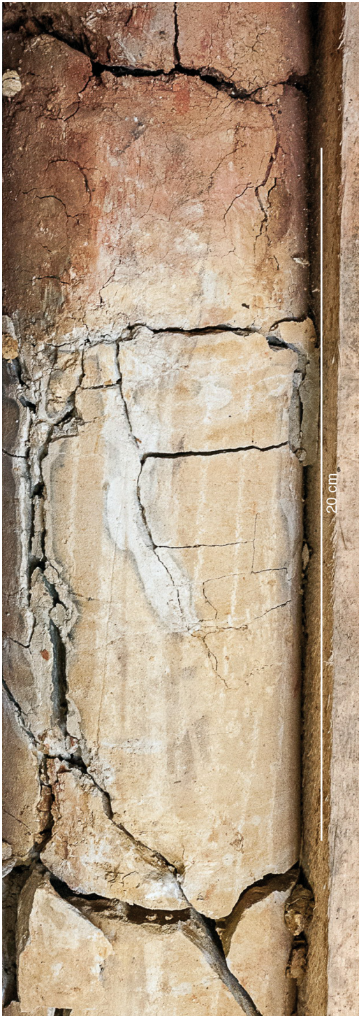
Abbildung 18 links. Großer Wurzelgang (14 cm lang und 2 cm breit) als hellgraue Verfärbung in LE 12 (Kernabschnitt 44,51-44,22 m).
