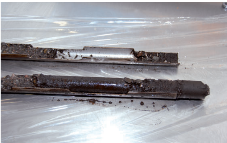
Abbildung 12. Das Innenrohr des neuen aufklappbaren Kraki-Bohrers.
