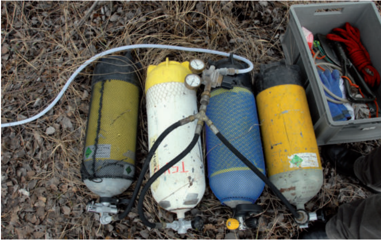
Abbildung 10. Die Luft für den Schlagbohrer kommt aus den 15-l-Flaschen.
