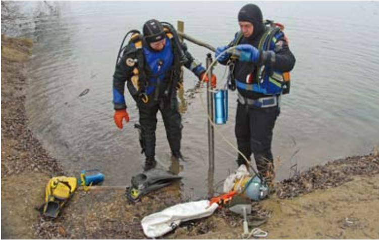
Abbildung 4. Zwei Taucher mit der Ausrüstung zum Erbohren eines Torfprofils. – Foto: REINHARD SCHOTTMÜLLER.
