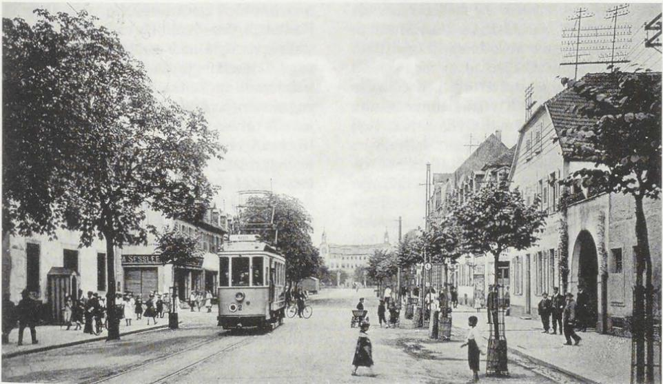
*Triebwagen 2 der Schwetzingener Straßenbahn auf dem Weg nach Ketsch. Gleich wird der Wagen von der Karl-Theodor-Straße in die Friedrichstraße einbiegen. Da die Strecke nach der Betriebsordnung für Kleinbahnen mit nebenbahnähnlichem Betrieb konzessioniert war, trägt er eine eisenbahnmäßige Schluss Scheibe. Poststempel vom 12. 7. 1917.*
