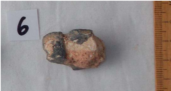
Abb. 7: Das Kleinbruchstück zeigt die Abfolge der roten und weißen Bettungsmörtelschichten.
