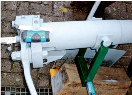
Sandstrahlbehandelte Kanone mit Rostschutzanstrich (Foto: Egon Morgenthaler)
