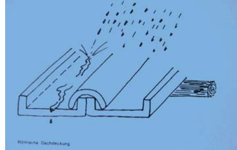
Abb. 4: Rekonstruktion: Römische Leistenziegel auf einem Dach
