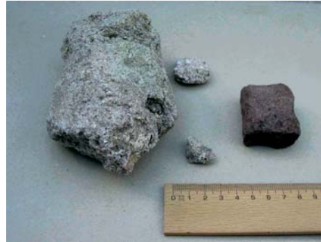
Abb. 14: Kalkmörtel und Buntsandstein – Baumaterialien der Burg.
