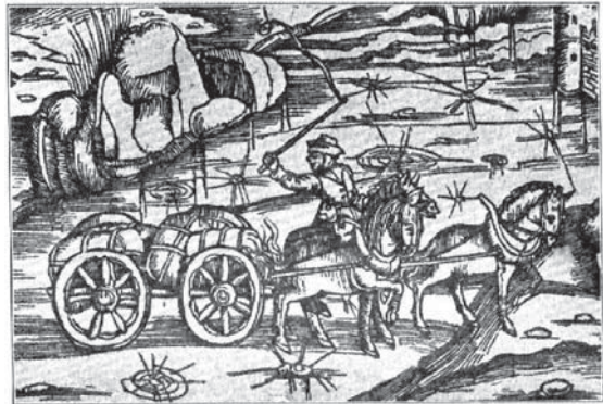
Abb. 4: Zweiachsiger Wagen, nicht lenkbar – Ausschnitt aus Sebastian Brant: Vergil Aeneis , Strassburg 1502. gemeinfrei URL < https://de.wikipedia.org/wiki/Datei:Frachtwagen.jpg >
