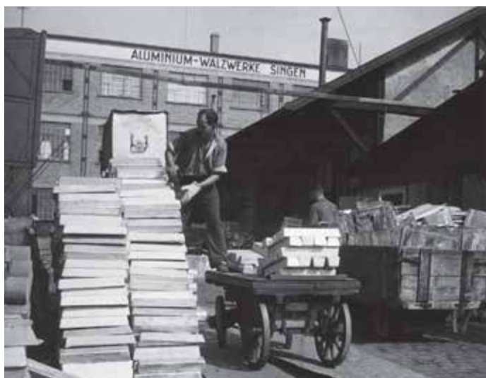
Abb. 9: Die gelieferten Aluminiumbarren bevor sie zum Elektro-Schmelzofen transportiert werden, Aluminium-Walzwerk Aktiengesellschaft, Singen 1937.
