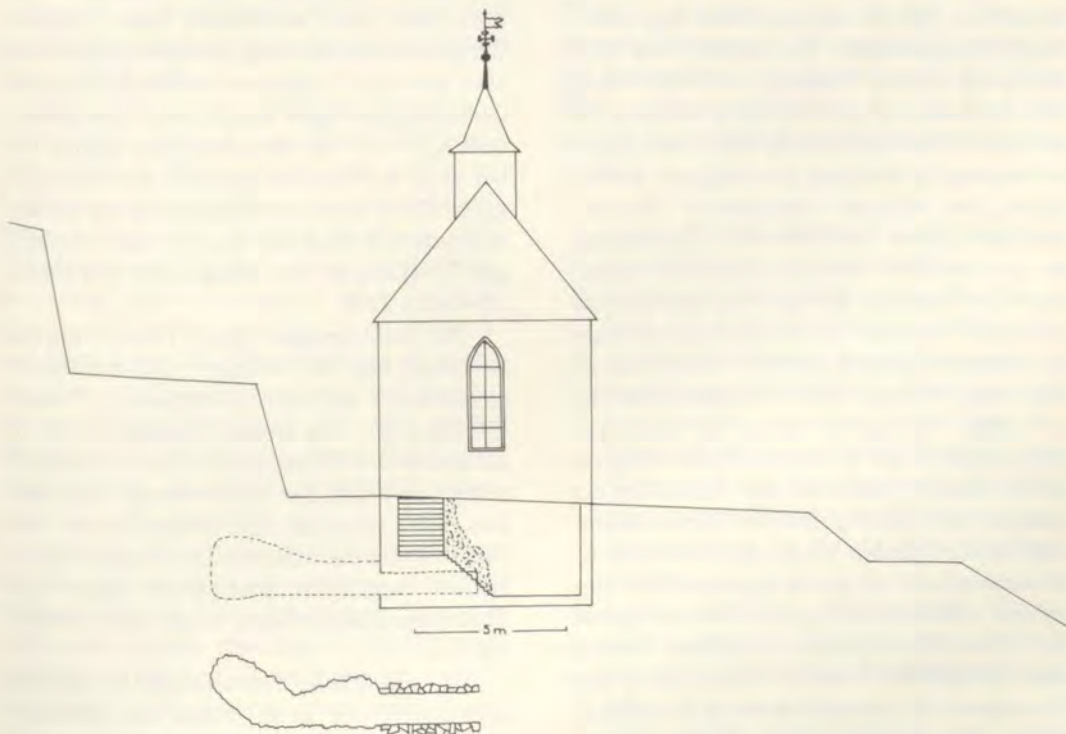
Abb. 2: Lage, Querschnitt und Grundriß des Quellstollens der St.-Ottilien-Kapelle.
