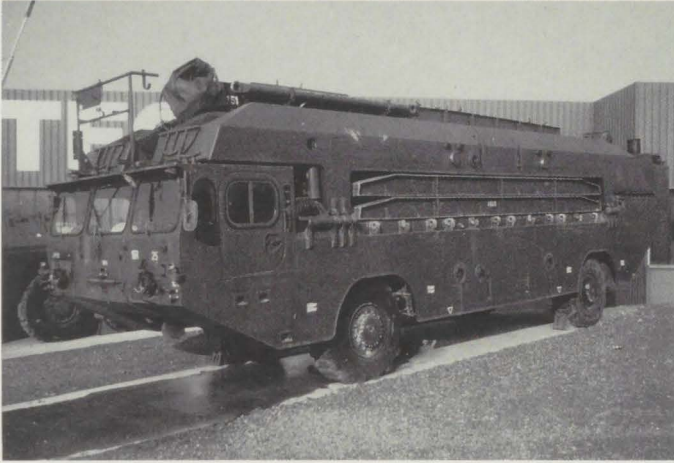
Unter den zahlreichen Militärfahrzeugen ist auch dieses Amphibienfahrzeug, das im Wasser zur Fähre aufgeklappt wird.
