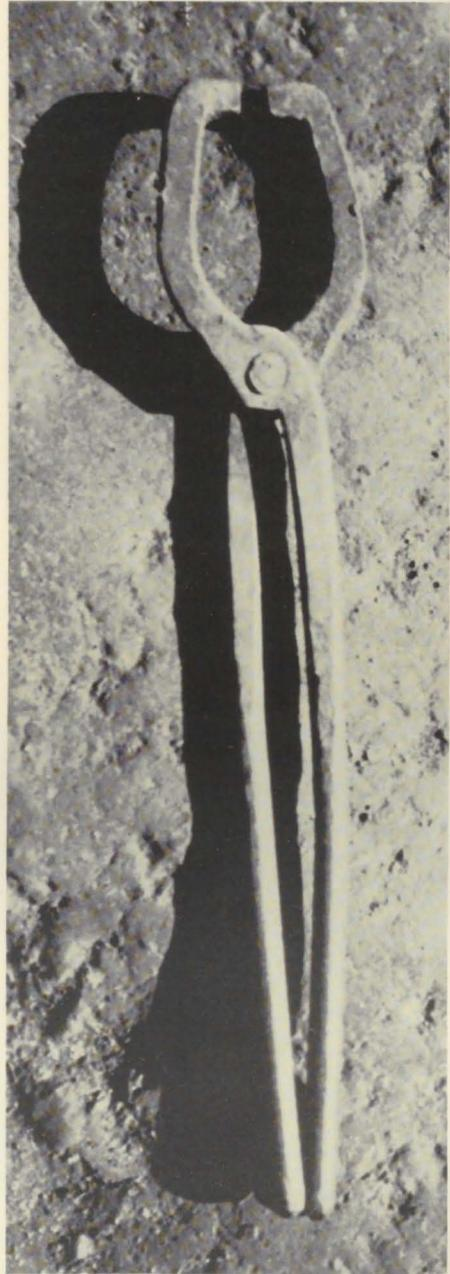
*Die Zugbandzange benötigt der Schmied für das Deichselzugband eines Wagenrades (Länge 49 cm).*
