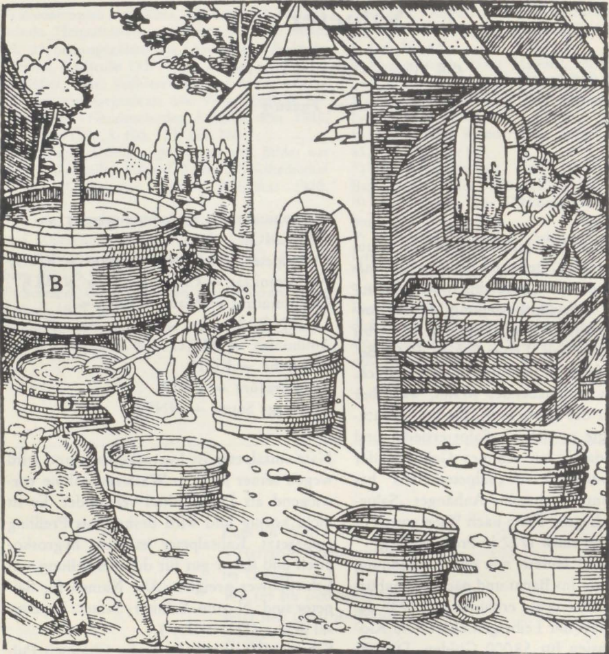
Georgius Agricola gab im 12. Buch seines Werks De re metallica die Darstellung einer Salpeter-Siederei. 1556. Für seine Behälter verwendete er den Ausdruck „Kufen“, die später als Bottiche und Standen bezeichnet wurden. Mit B+D+E sind Bottiche verschiedener Größe dargestellt. Der Zapfen C dient zum Ablassen der Lauge. In Kufe E sind Kupferstäbe eingebaut, an denen der Salpeter auskristallisiert. In Pfanne A wird die Lauge eingedickt.
