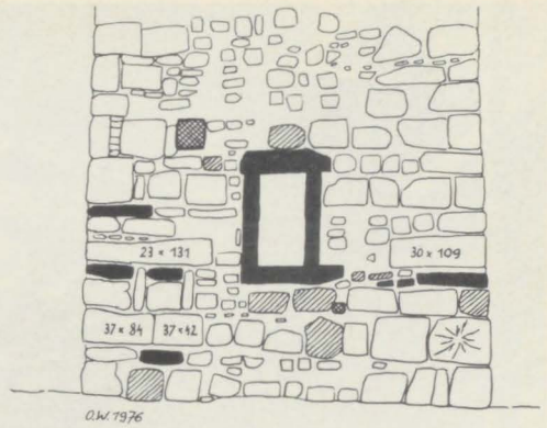
3) Turm, Struktur der Südwand (eingetragene Maße in cm).
