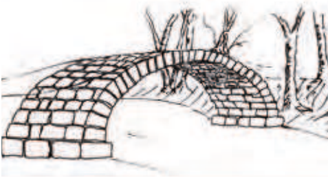
Skizze des »Rohbaus« einer Bogenbrücke, auf der man die keilförmigen, radial gesetzten Gewölbesteine und deren Anordnung sieht. Die Quader müssen sich innig verzahnen, damit das Gewölbe stabil wird. Dann kann der Überbau folgen.
