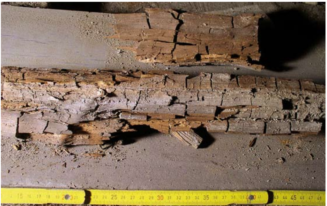
Abbildung 4. Braunfäule (Würfelbruch) des Holzes nach Befall durch Serpula lacrymans . – Foto: MÄTES II, Wikipedia.
