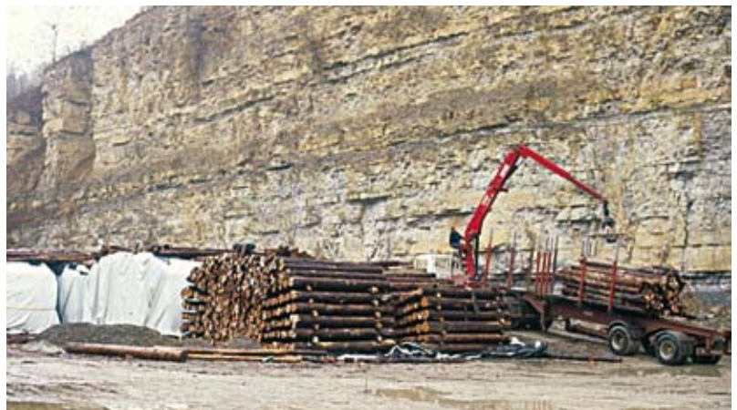
Abbildung 18. Abbau eines Versuchspolters zur Lagerung von Fichtenholz in Schutzgasatmosphäre.
