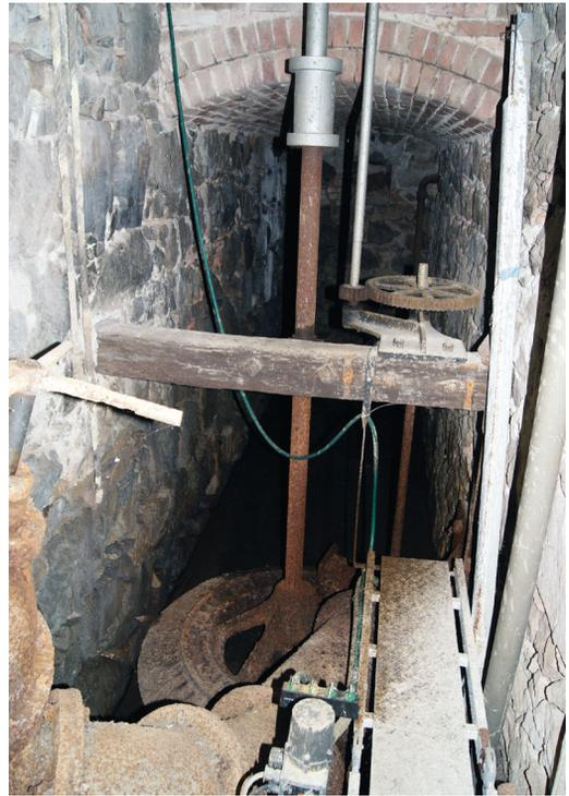
Abb. 18: Turbinenanlage mit Zulaufrohr (vorne links) aus dem Montfortweiher im Tiefkeller der ehemaligen Mühle, erbaut von Camill Montfort 1887. Hauptantrieb für zwei Mühlsteine, Nebenantrieb für Sackaufzug. Foto: Cornelia Korff 2020.
