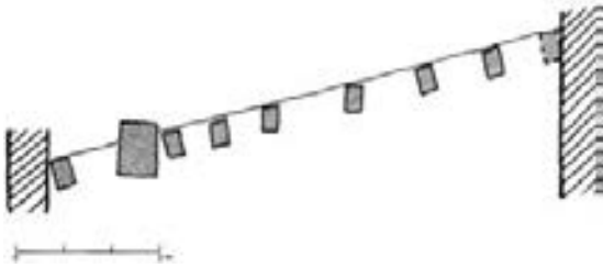
Abb. 45: Schweiz, Riehen, Meierhof, Kirchgasse 20, Balkenlöcher eines ehemaligen Pfettendaches.
