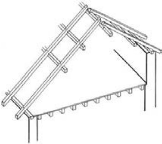
Abb. 38: Villingen, Brunnenstraße 36, Perspektivische Darstellung des von freigespannten, Rofenunterzügen getragenen Rofendaches 1322(d).
