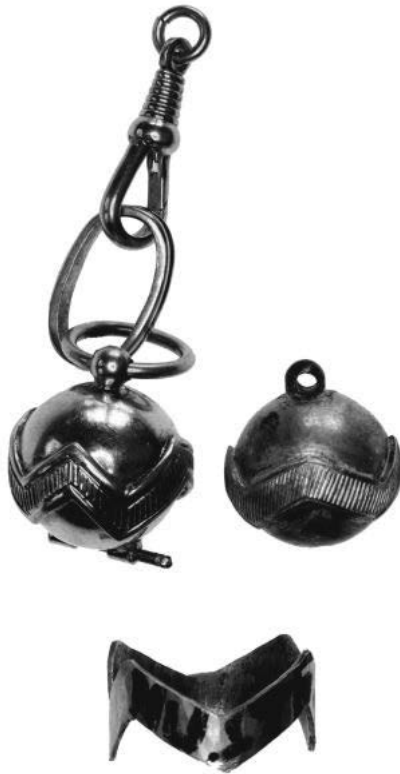
Unten: Der Ring aus Silberblech mit den fertigen Konturen wird auf die Kugel aufgelötet. Nach Anbringung des Bandringes und der Scharnierböcke wird das Ganze vergoldet und poliert.
