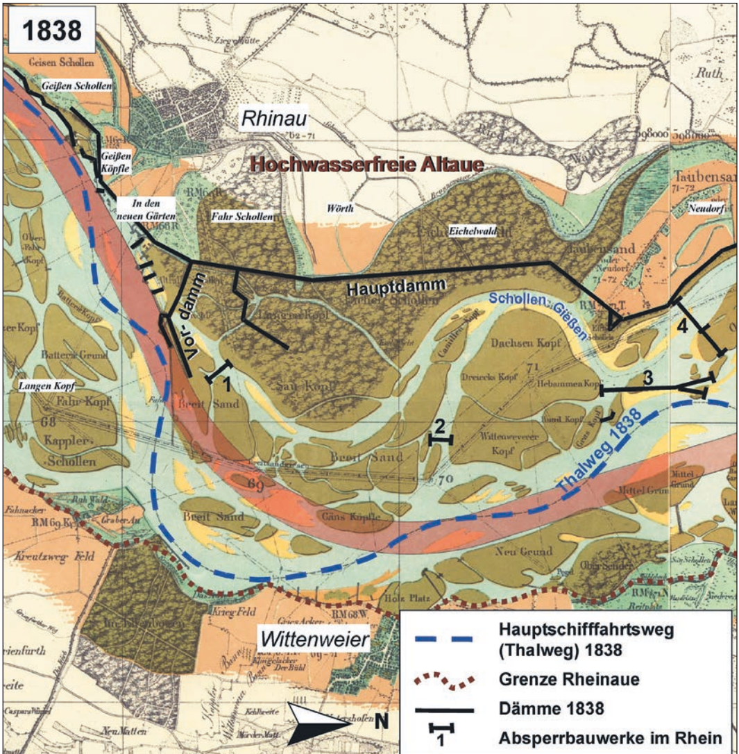
Abb. 10: Ergebnis der Rheinverlegung: Landgewinnung und Nutzungsänderung im Schutz von Dämmen und Bauwerken im Rhein bei Rhinau.
