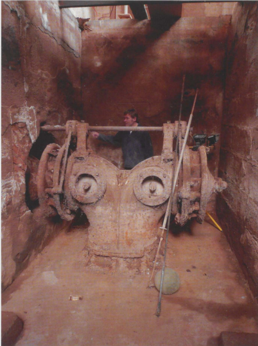
Francis-Zwillings-Turbine mit dem heutigen Besitzer der Kunstmühle, Wendelin Himmelsbach. Bild: M. Himmelsbach.
