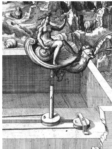
Abb. 3 [de Caus/1. Buch:] Galatea im Muschelboot, auf der Antriebswelle montiert (Ausschnitt) (UB Heidelberg)
