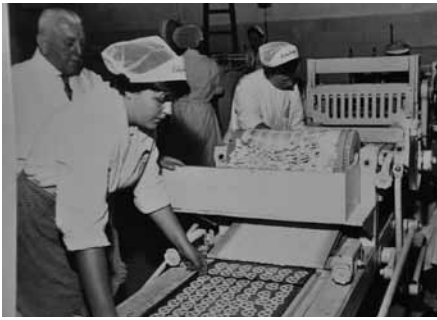
Links: Ausstanzmaschine für Brezeln. Rechts: Abwiegen und Verpacken von Hand (Foto: Archiv G. Lulay)
