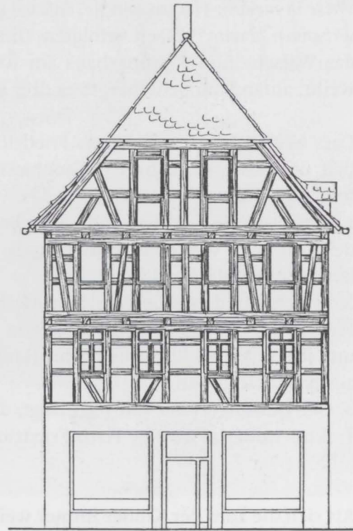
Abb. 3 Barockes Fachwerk des Hauses Friedrichstraße 15, thermografische Untersuchung 1980.
